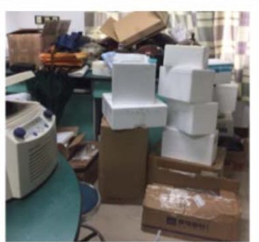
图 5. 实验室内不得堆积易燃物 (纸箱、泡沫箱等)
